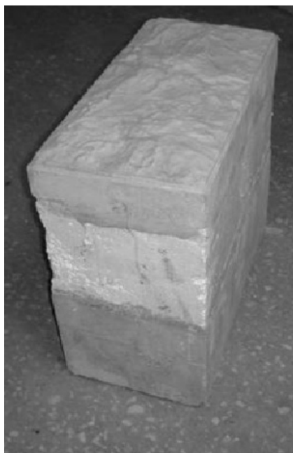
Рис. 1. Рядовой многослойный блок БР40-30-20 (400×300×200 мм)
